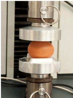
Photo: Mesure de la qualité de coquille
