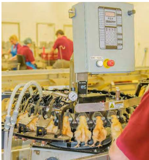
Photo: Epointage par la méthode infra-rouge
